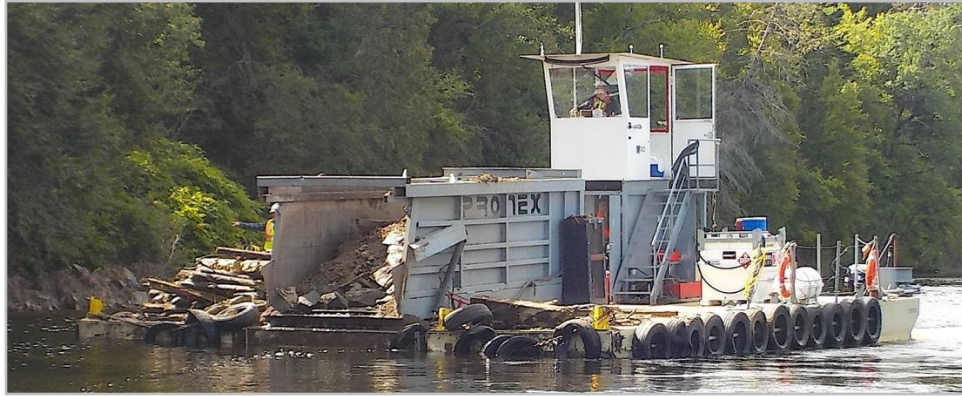
Figure 52 : Barge avec sa benne munie d'un mur poussoir (26 août 2020).
