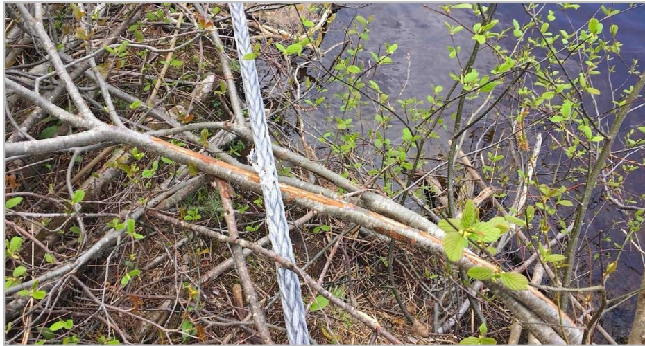
Figure 29 : Usure du câble de l'estacade par le frottement contre une tige d'arbuste (12 juin 2019).
