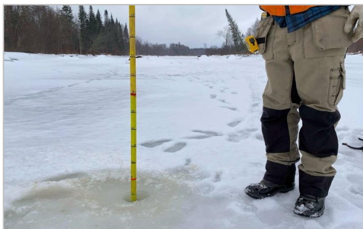
Figure 116 : Sondage du couvert de glace, le 28 février 2024, à 20 m en amont du SRG.
