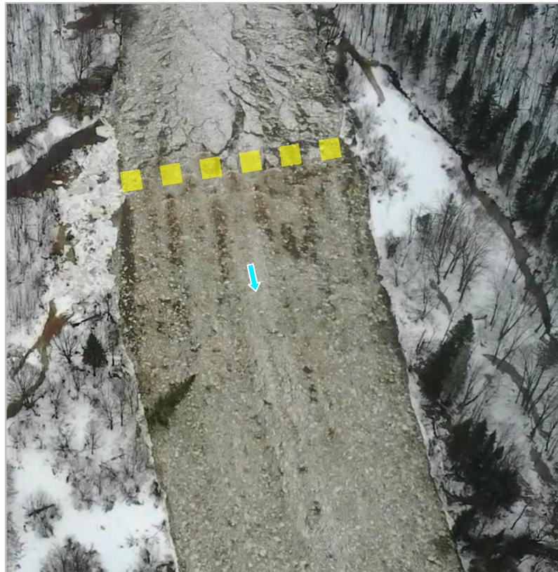
Figure 115 : Fragmentation de la glace par le SRG le 19 décembre 2023. La rangée amont des blocs du SRG est surlignée en jaune.
