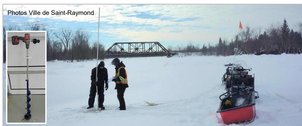
Figure 4 : Mesure des épaisseurs de la glace et du frasil sur la rivière Sainte-Anne, le 13 janvier 2019.
