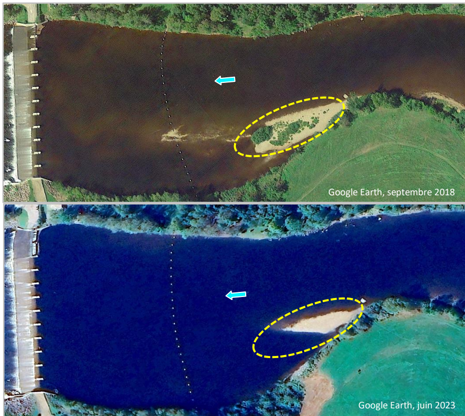
Figure 95 : Comparaison des accumulations avant les travaux en 2018 et une année après en 2023.
