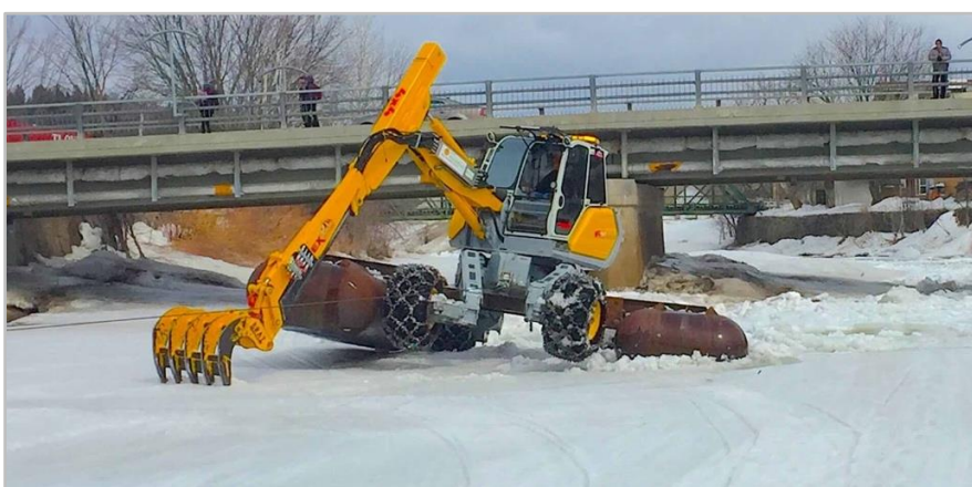
Figure 8 : Pelle-araignée munie de flotteurs et tractée par un câble d'acier, le 3 avril 2018.
