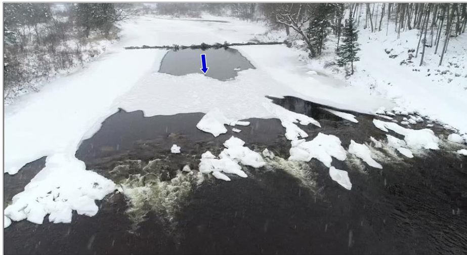
Figure 36 : Formation précoce du couvert de glace en amont de l'estacade le 14 novembre 2019.
